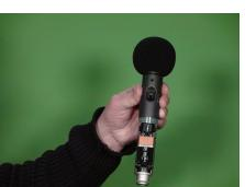
Ce micro utilise une pile de 9 volts, d'où l'importance de la remettre à zéro après usage. Pour changer la pile, dévisser le micro...
